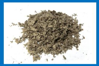
Базальтовое волокно является высокомодульным продуктом, превосходящим стекловолокно и обеспечивающим экономичную дополнительную длину и эффективность лопаток ветряной турбины.
