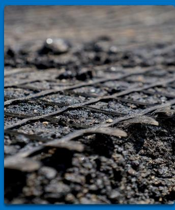
Используется для стабилизации основания методом армирование грунта; Применяется для армирования грунтовых конструкций при строительстве автомобильных, железных дорог, гидротехнических сооружений, трубопроводов, полигонов для размещения отходов, укрепления грунтовых оснований фундаментов, а также противоэрозионной защиты откосов насыпей и котлованов с использованием растительного грунта и посевом трав; Применяется для укрепления подпорных конструкций и крутых откосов с помощью армирования грунта;
